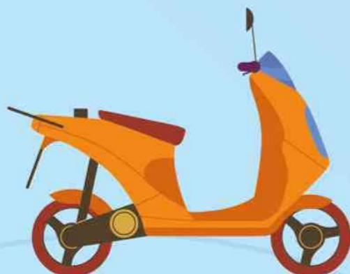
**«Мопед»** — двух- или трехколесное механическое транспортное средство, максимальная конструктивная скорость которого не превышает 50 км/ч, имеющее двигатель внутреннего сгорания с рабочим объемом, не превышающим 50 куб. см, или электродвигатель номинальной максимальной мощностью в режиме длительной нагрузки более 0,25 кВт и менее 4 кВт. К мопедам приравниваются квадрициклы, имеющие аналогичные технические характеристики.
